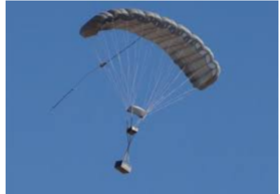
Figuur 11.2: voorbeeld van een parafoil parachute (NASA, Guided Parafoil High Altitude Research II. (n.d.)).
