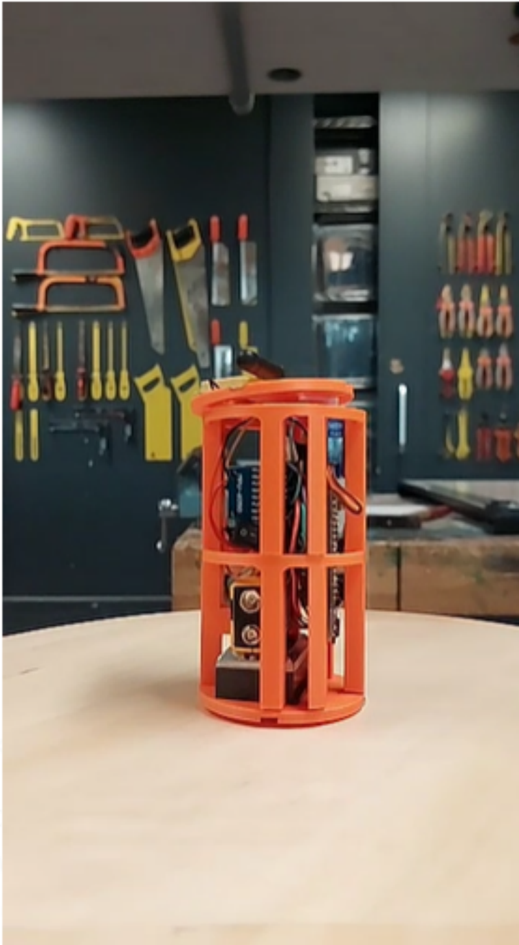
Figuur 9.4 Definitief frame van de CanSat met alle bijbehorende hardware.
