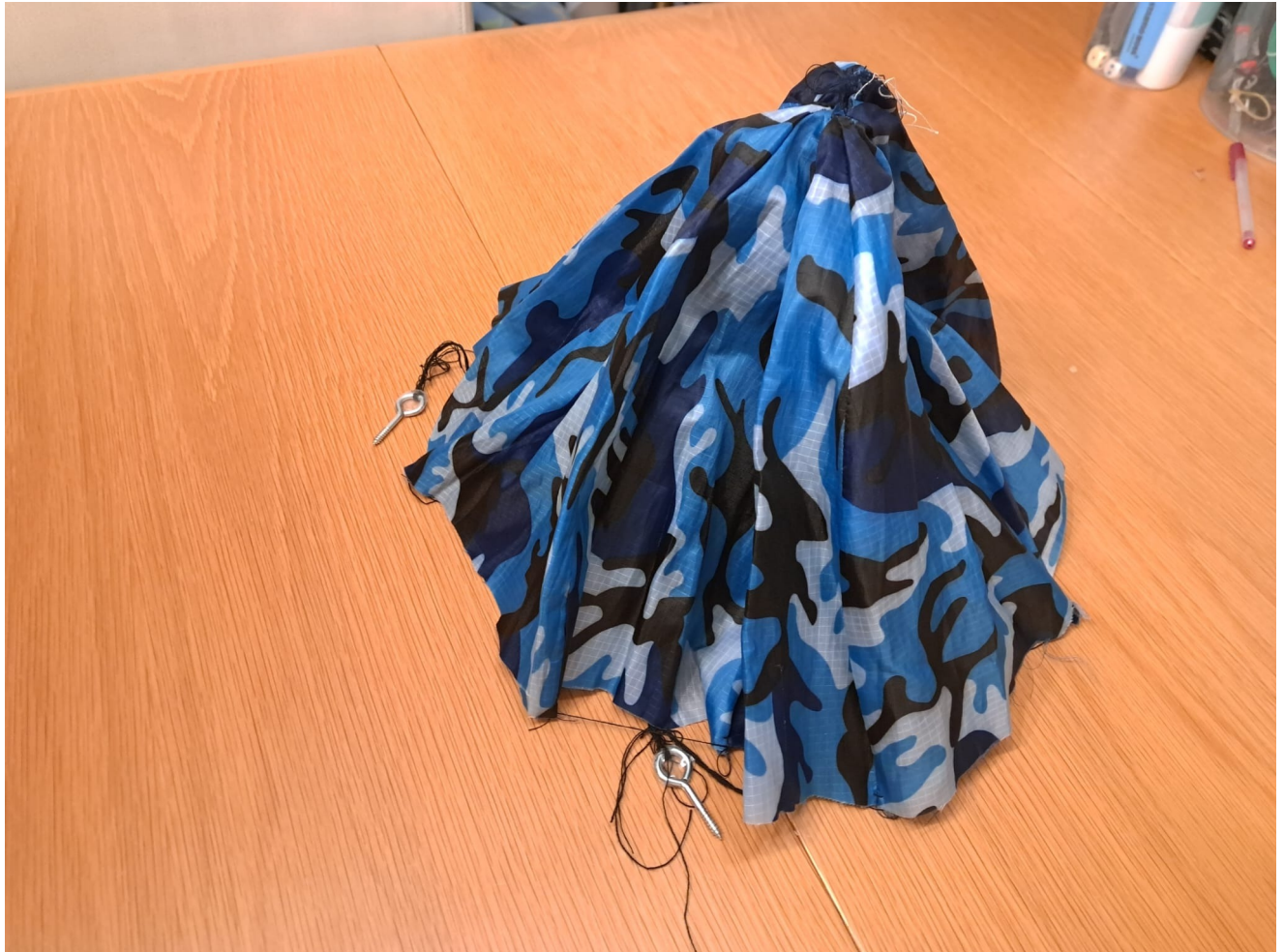
Figuur 9.5 Definitief ontwerp van de parachute van de CanSat.
