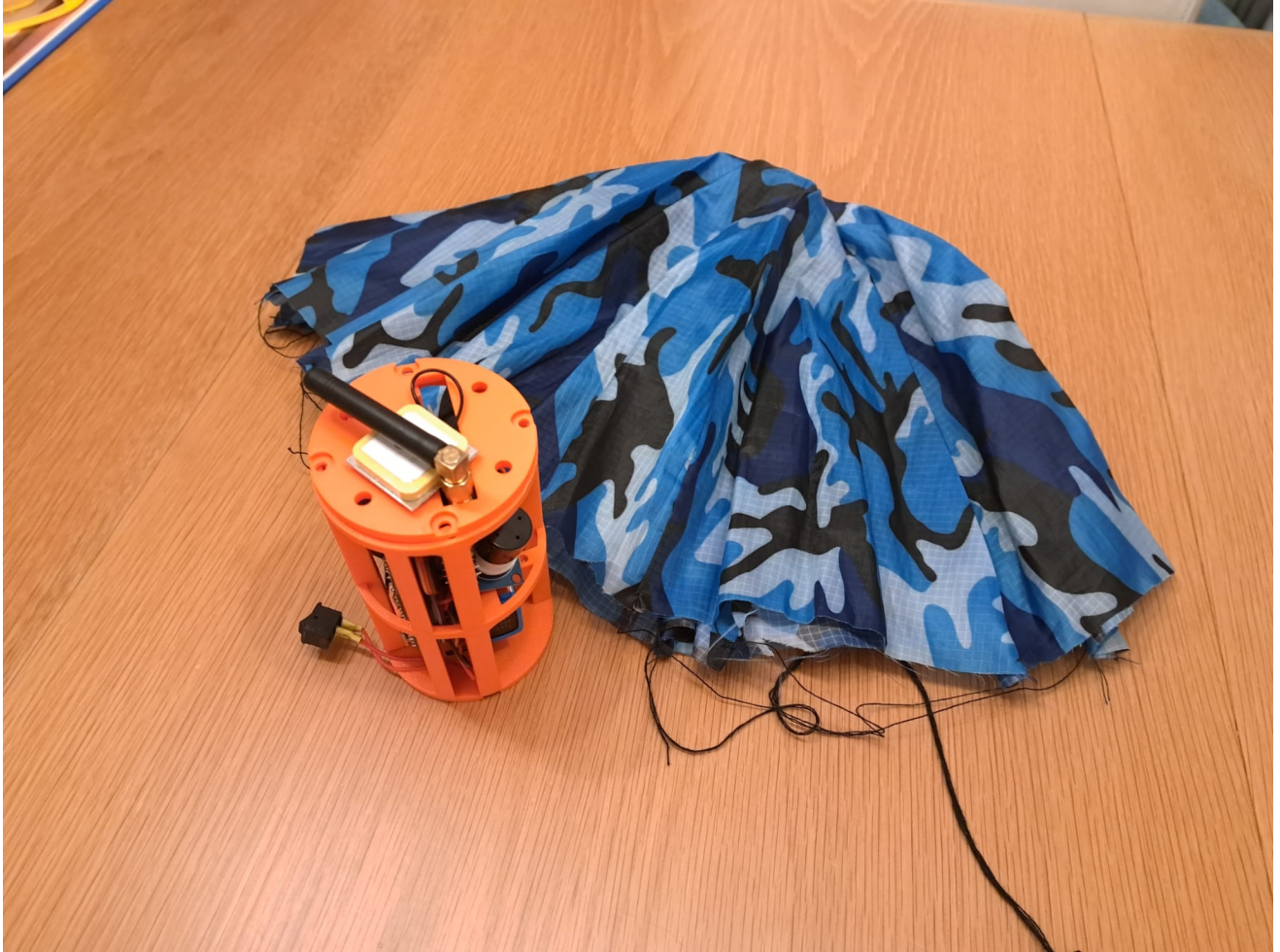
Figuur 9.6 De parachute geplaatst naast de CanSat met alle bijbehorende hardware.
