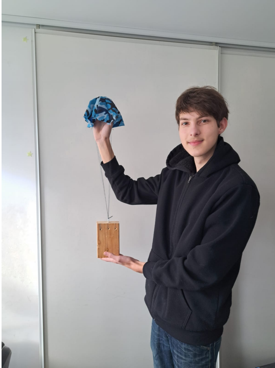
Figuur 8.7 Pepijn met de parachute met daaraan vastgebonden een blok hout met gelijkbaar gewicht als de CanSat.
